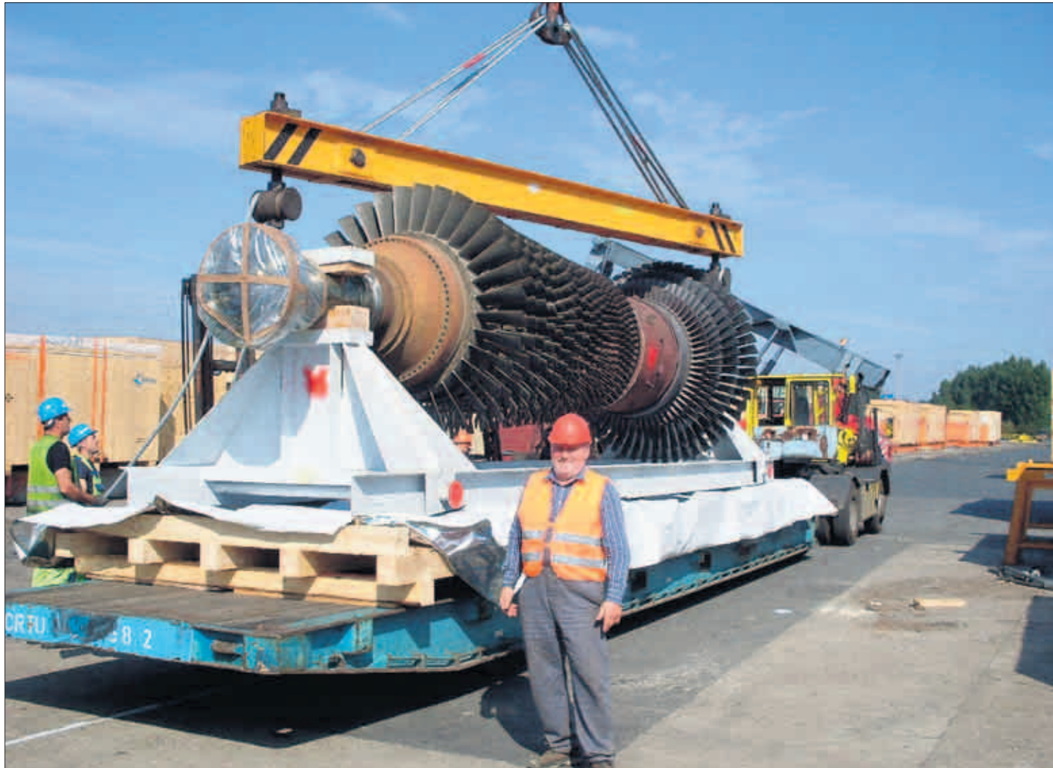
Die empfindliche Turbine muss mit Hilfe einer Spezialtraverse transportiert werden. Die kleinste Delle in einem Flügel, und das Teil wäre unbrauchbar. Der Technische Leiter Uwe Asmus ist mit der Demontage zufrieden.
